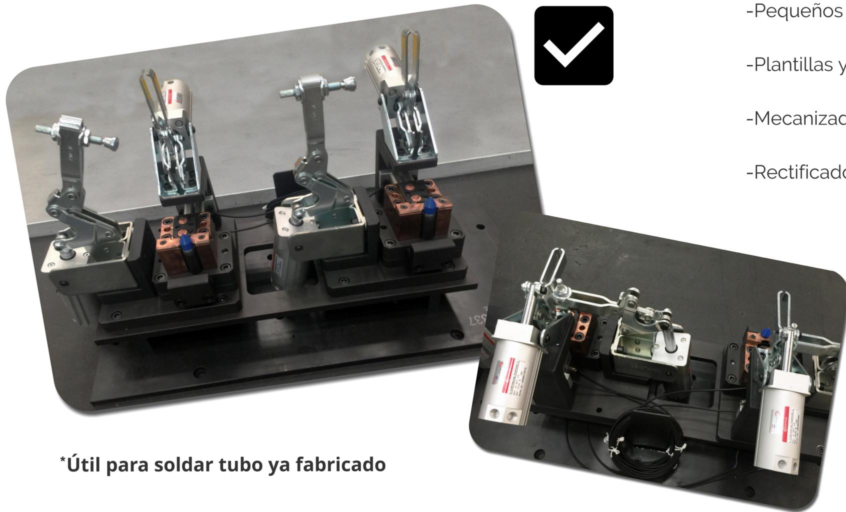
\*Útil para soldar tubo ya fabricado
